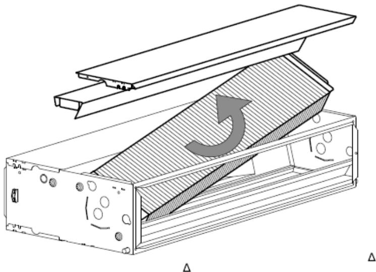
Поверните теплообменник таким образом, чтобы его края находились на противоположных сторонах обмотки.
